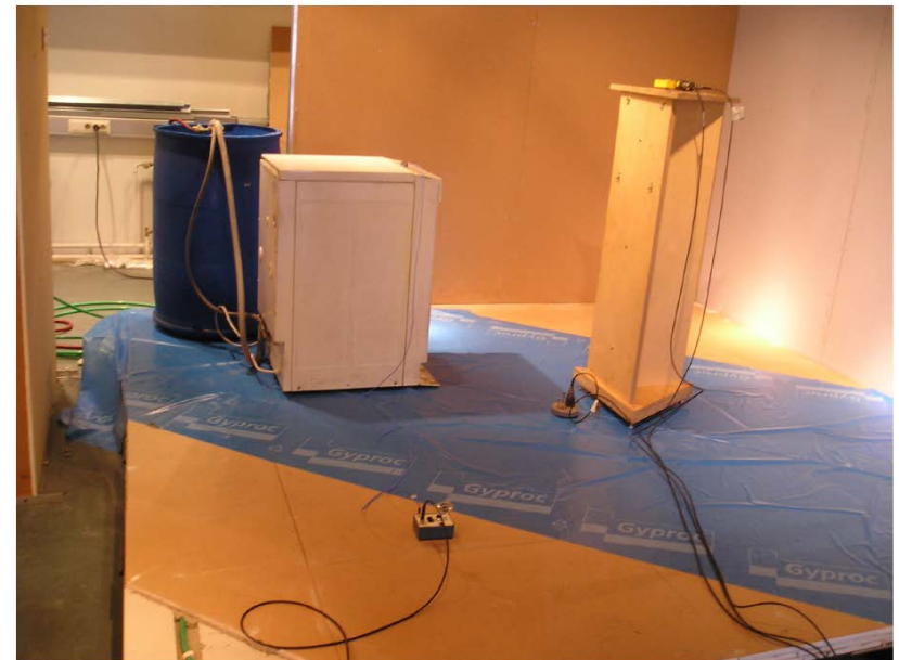
Kuva 16. Yleiskuva koetilanteesta. Pesukone vasemmalla ja kiihtyvyyssanturi lattian keskellä.
