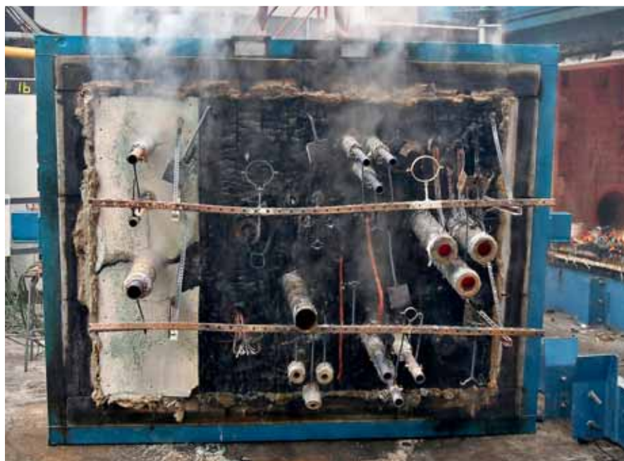
Osastoiva, 80mm CLT- seinä 68 minuutin polton jälkeen. Kylmällä puolella kaikki kunnossa. | Fire-separating wall (80mm CLT) after 68 minutes of exposure to fire. Everything in good condition on the cold side.
