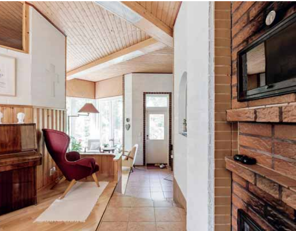
Pienehkön talon avaruus perustuu 45 astetta taitettuun kylpyhuonetilään, ja näin ulko-ovesta tultaessa voi nähdä läpi talon. Oleskelutila on 3,6 m korkea, ja 2,4 m korkeat kulmaikkunat etelään ja länteen tuovat istujan luonnon keskelle. Talo on ”halkaistu” pitkittäin keskeltä 80 cm korkeuserolla tontin muodon mukaan.
