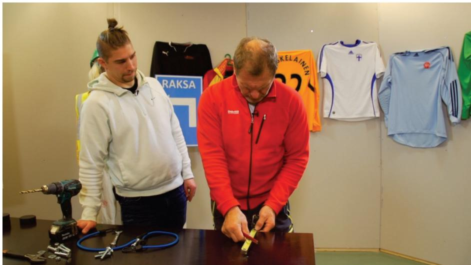
2. Poraa hieman pulttia pienemmällä terällä kummankin pultin kohdalle reiät vaneriin. Esimerkissä porataan 9 mm reikä 10 mm pulille, jotta kiinnitys on jämäkkä.
