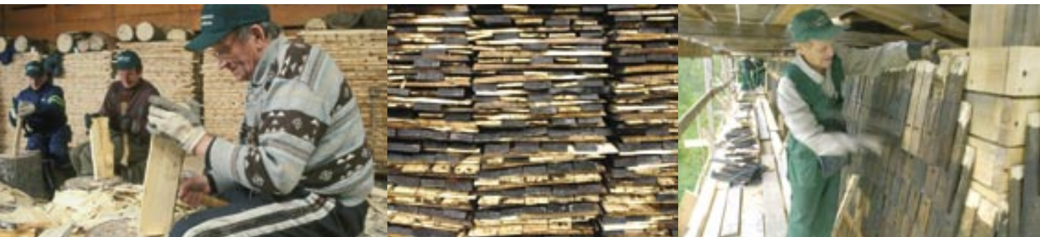
Haapapaanut lohkotiin, sivut veistettiin, paanut upotettiin tervaan ja kiinnitettiin taotuilla nautoilla.
