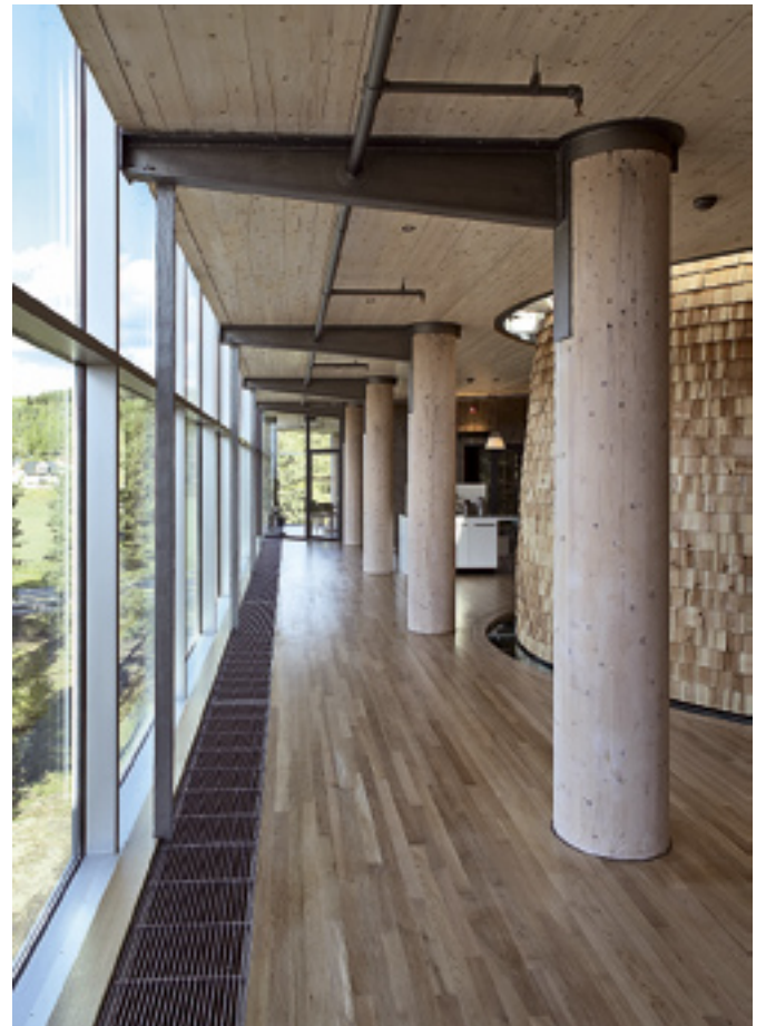
Liimapuupilarit ovat kantavana rakenteena ikkunaseinillä. Toimisto- osat ovat liimapuulevyrakenteisia. Yläkerroksen koivupintainen neuvottelutila lävistää katon ja aukeaa taivaalle.
