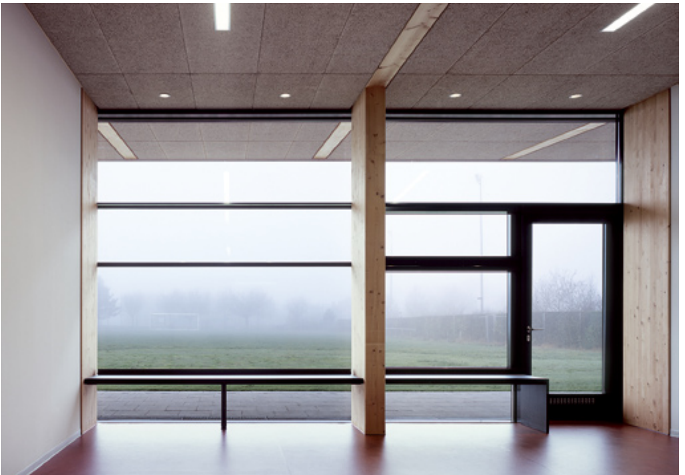
Pitkät lipat suojaavat ikkunaseiniä sekä sisätiloja liialta auringonsäteilyltä.
