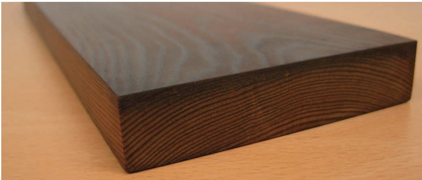
Pinnastaan puristettua lämpöpuuta. Heat-treated wood with densified surface.
