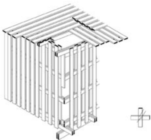
Aksonometria verkkomaisesta rakenneperiaatteesta
