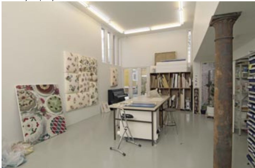
Laajennusosan seinien pinnoitteena on 2-kertainen mdf-levy, mikä mahdollistaa kiinnitykset pintojen rikkoutumatta. Vanhat tiiliseinät kalkkimaalattiin.
