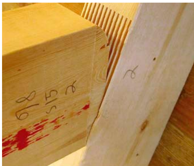
Kulmasormiliitoksen aihioita. T-sormiliitos
