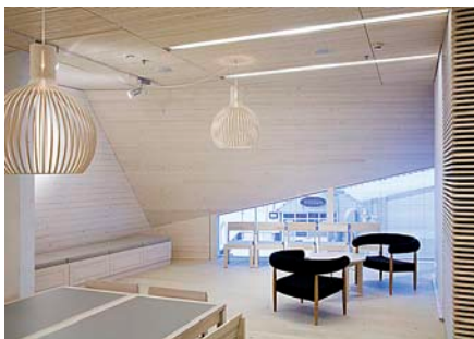
Sisäpinnat ovat säteittäissähattua, vaalennettua kuusta. The interior panels are in radially-sawn white spruce.
