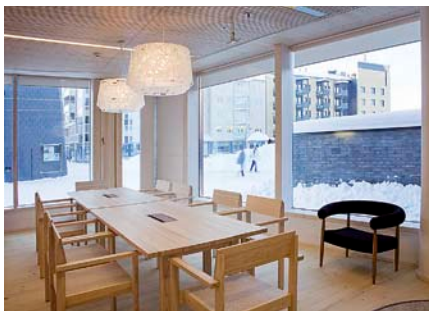
Sisäpinnat ovat säteittäissähattua, vaalennettua kuusta. The interior panels are in radially-sawn white spruce.
