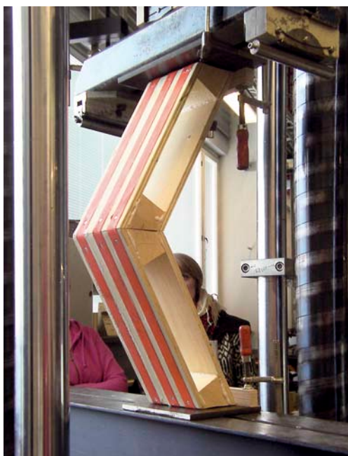
Liinaliitoksen testaus Strap-joint test
