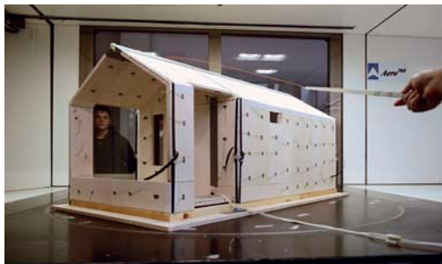
Tuulitunneli koe Wind-tunnel test
