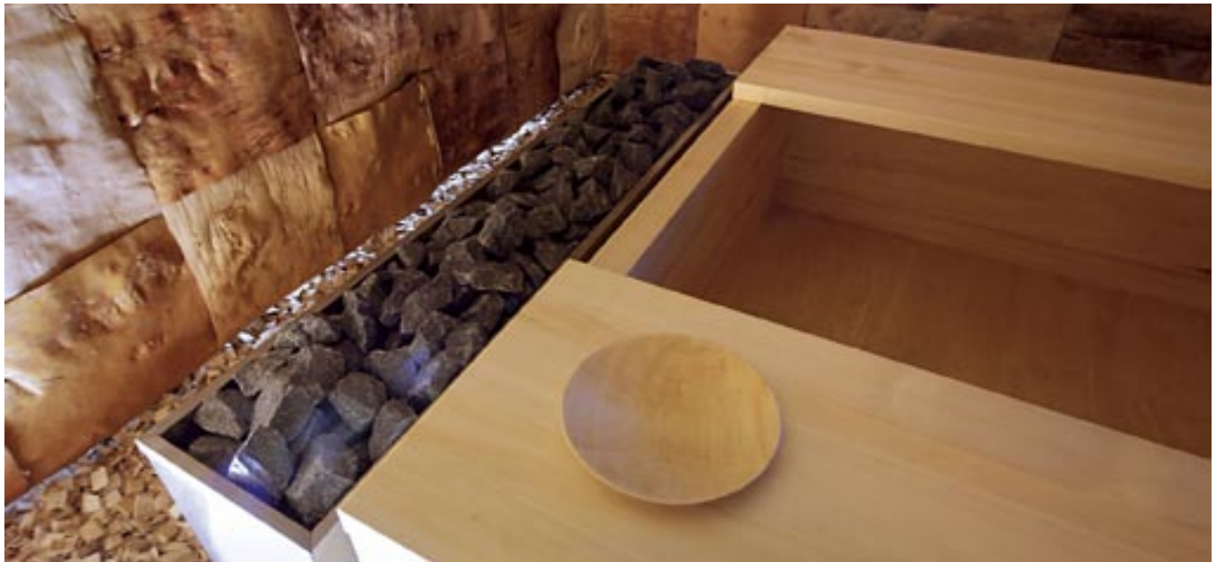
Saunan sisällä ovat saunomisen peruselementit puu, vesi ja lämpö. Massiivihaapalankuista valmistettu vesiallas, liikuteltavat laudetasot ja kiuas muodostavat saunan ytimen.
