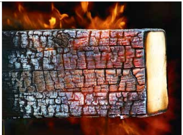
Kuva 69. Puun palaessa sen pintaan muodostuu hiilikerros, joka hidastaa puun sisäosien lämpenemistä ja samalla puun palamista.
