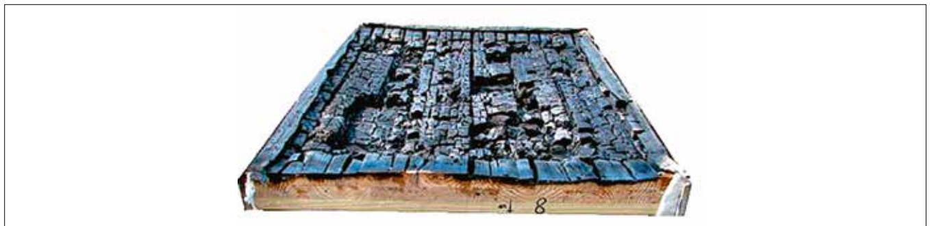
Kuva 70. CLT-levyn delaminoituminen polttokokeessa.
