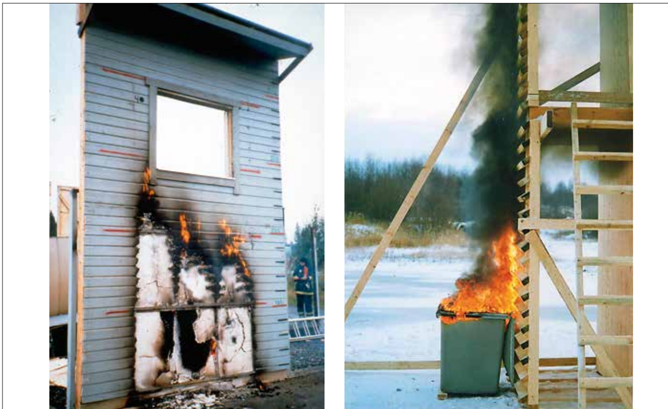
Kuva 38. Julkisivupaloja on tutkittu polttokokeilla. Kuvat: Markku Karjalainen
