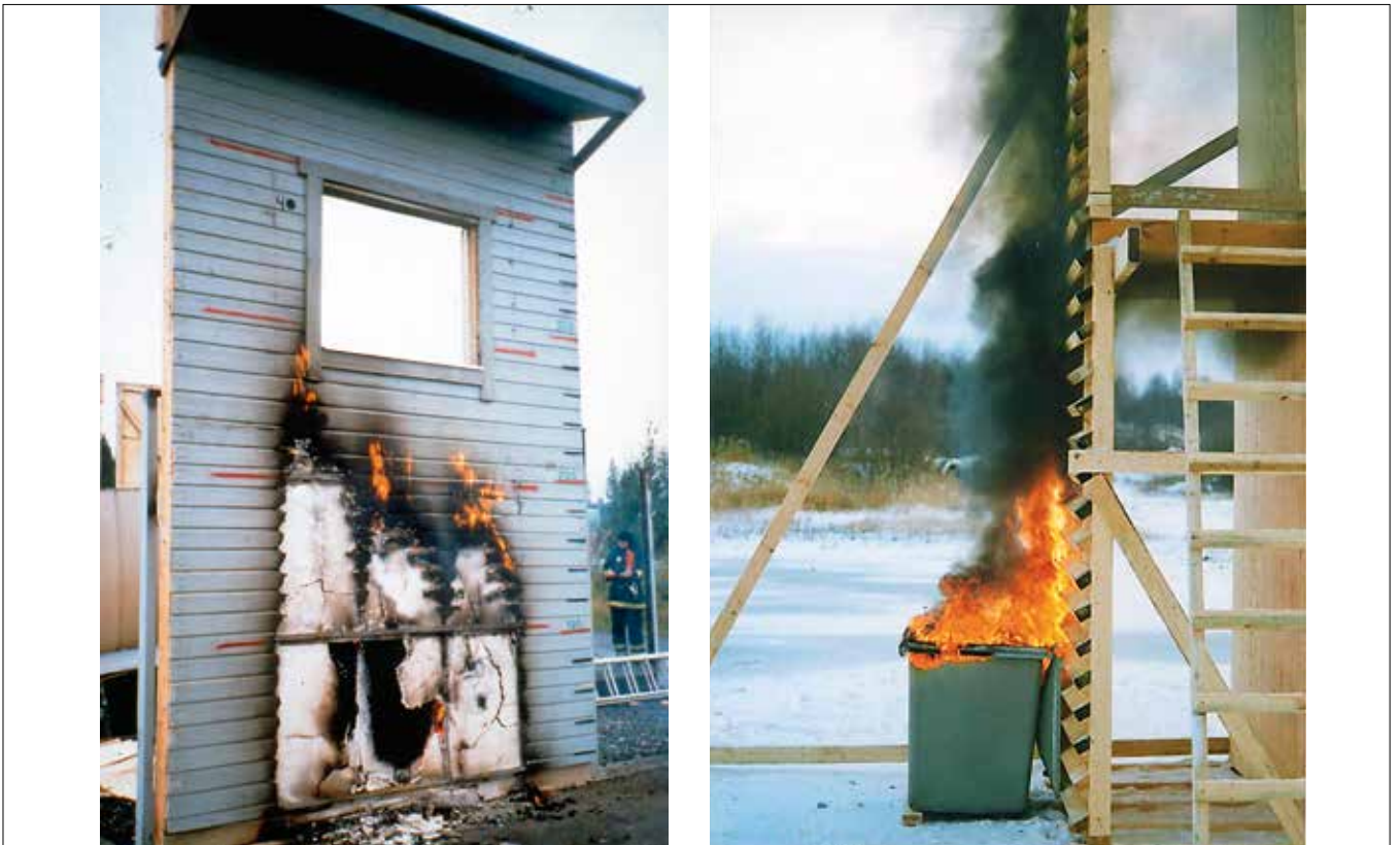
Kuva 38. Julkisivupaloja on tutkittu polttokokeilla. Kuvat: Markku Karjalainen
