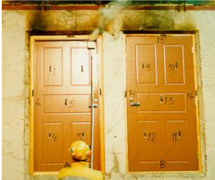
Kuva 2. Oven polttokoe EN-standardin mukaan.
