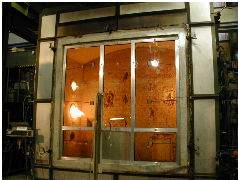
Kuva 1. Lasirakenne EN-standardin mukaisessa palonkestävyysskoeksessa.
