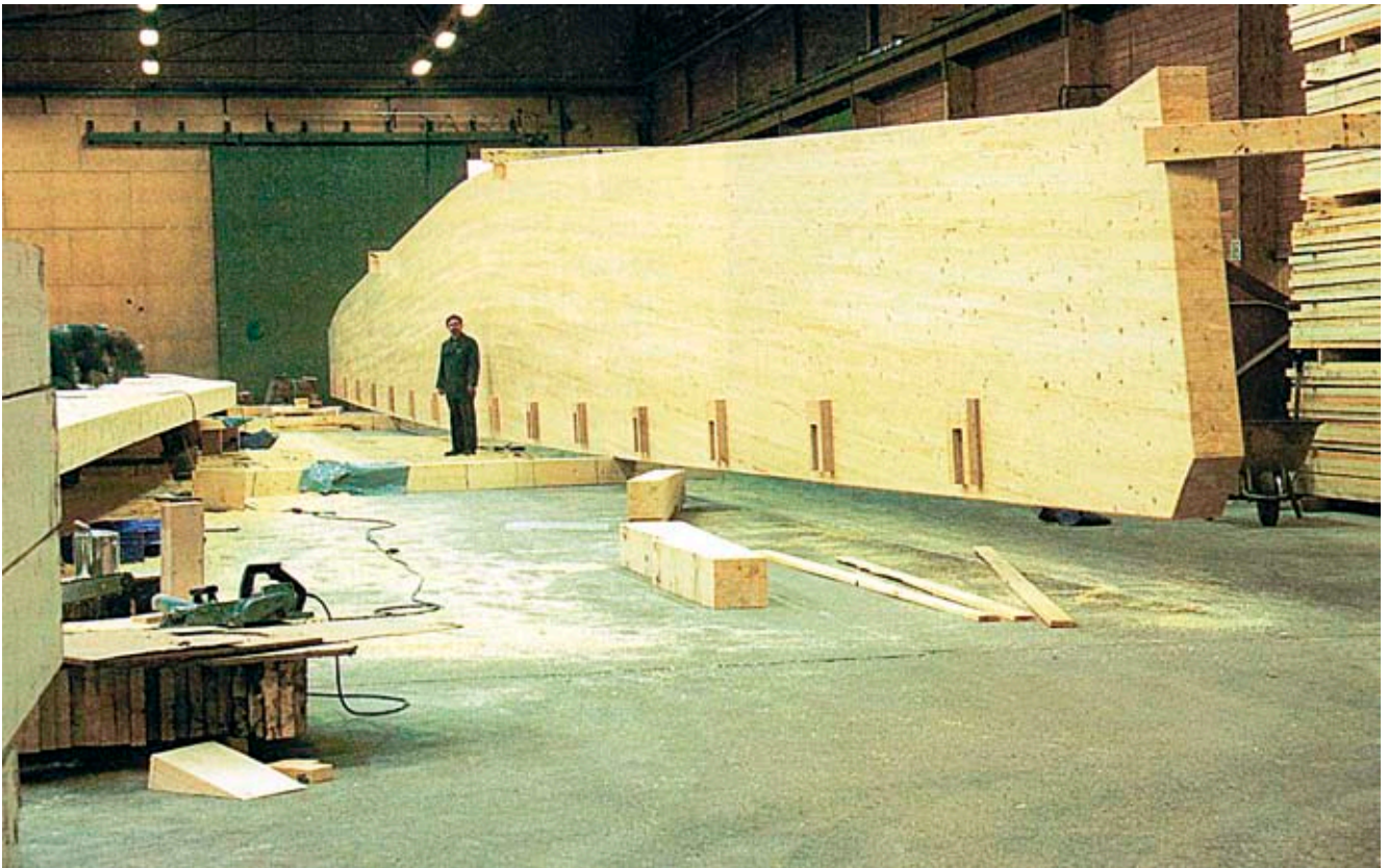
Kuva 10.11 Jättimäinen liimapuupalkki viimeistelyvaiheessa.
