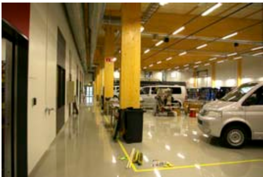
Kuva 4.4 LVI- tekniikan vaatima tila voidaan sijoittaa järkevästi myös palkkien alle esim. kulkureiteille tai seinien viereen.
