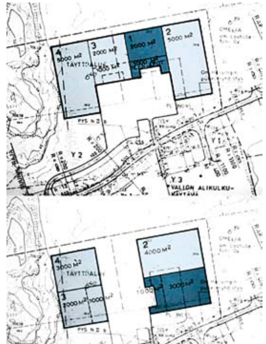
Kuva 3.5 Kaksi tontin käyttösuunnitelmaa, jotka tarjoavat hallille erilaisia laajennusvaihtoehtoja.
