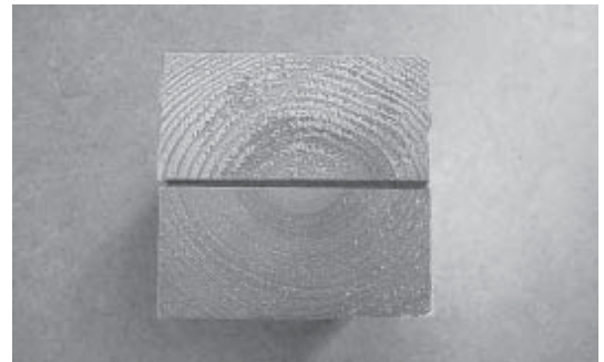
Kuva 115 c Polyteeninauha yläohjauspuiden välissä (paksuus 3 mm).
