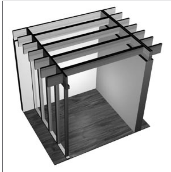
Kuva 36. Märkätilan välipohjalla oma palkisto ja kantavat seinät.
