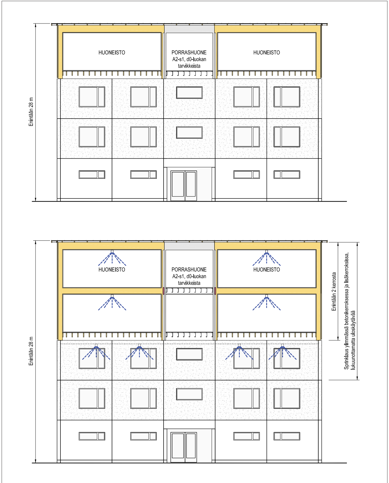
Kuva 63. P1-paloluokan asuinkerrostalossa voi olla yksi lisäkerros ilman sprinklausta ja kaksi lisäkerrosta, kun kolme ylintä kerrosta sprinklataan.
