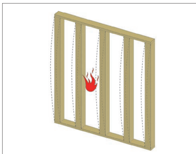
Kuva 81. Riittävän järeät tolpat voidaan suunnitella toimimaan ilman nurjhdustuenta.
