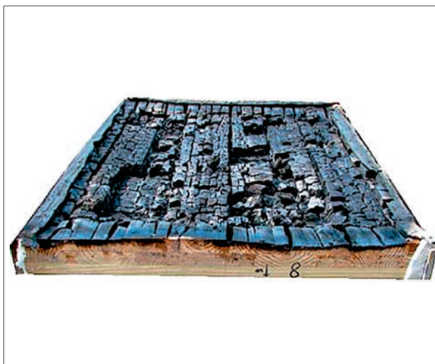
Kuva 74. CLT-levyn delaminoituminen polttokokeessa.
