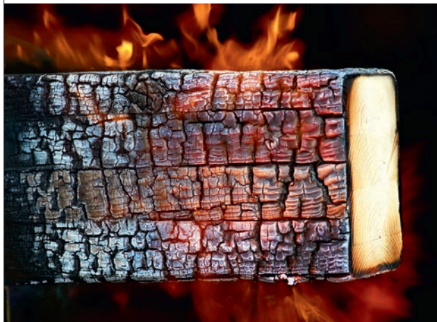
Kuva 73. Puun palaessa sen pintaan muodostuu hiilikerrok, joka hidastaa puun sisäosien lämpenemistä ja samalla puun palamista.
