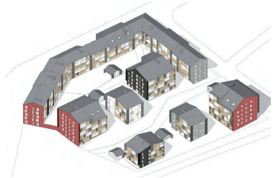
Porvoon Länsirannan puukorttelin asemakaavan havainnekuva. Rakennukset on tarkoitus toteuttaa massiivipuurakenteisina ja pysäköinti toteutunee betonikannen alle. (Kuva: OOOPE-AA Office for Peripheral Architecture.)
