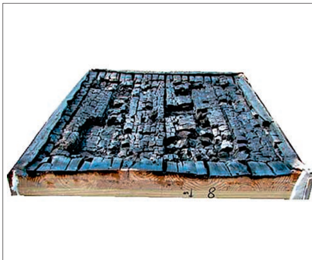
Kuva 74. CLT-levyn delaminointuminen polttokokeessa.
