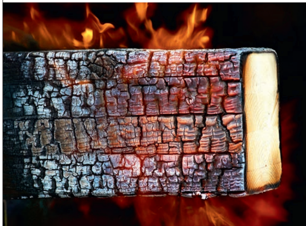
Kuva 73. Puun palaessa sen pintaan muodostuu hiilikerros, joka hidastaa puun sisäosien lämpenemistä ja samalla puun palamista.
