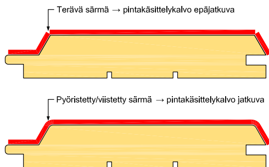
Kuva 20: Pintakäsittelytyypistä riippuen särmänsäpyörityksen/-viisteen avulla pintakäsittelykalvosta saadaan paremmin jatkuva verrattuna terävään särmään
