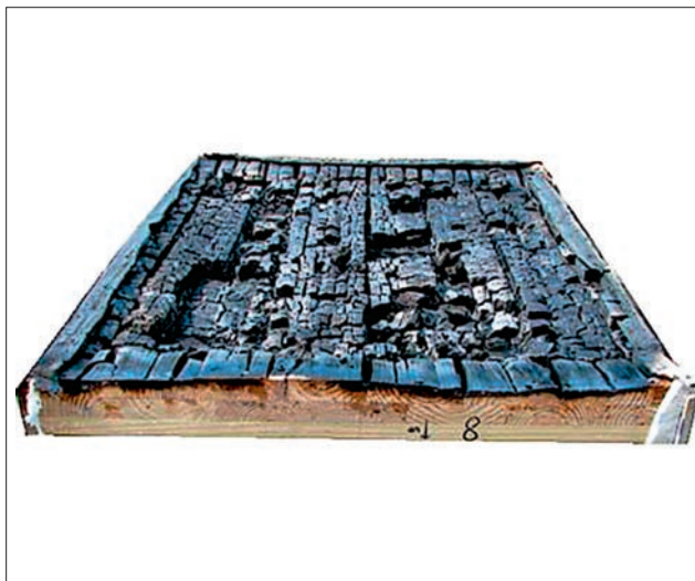
Kuva 74. CLT-levyn delaminointuminen polttokokeessa.
