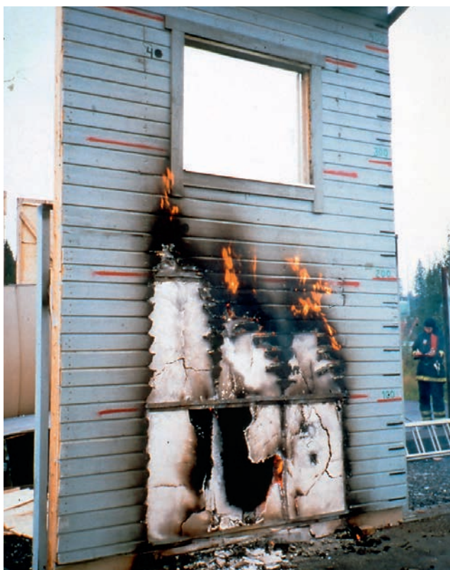
Kuva 39. Tuuleturaon palokatkot rajoittavat julkisivuvapalon leviämistä tehokkaasti. Kuva: Markku Karjalainen
