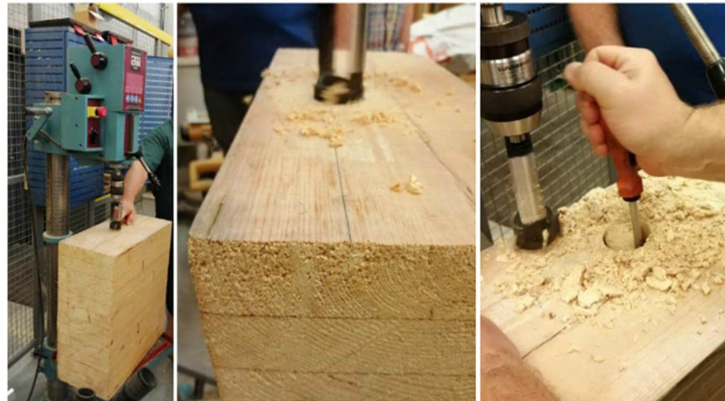
Kuvat 5, 6 ja 7. Poratappinäytteiden poraus.
