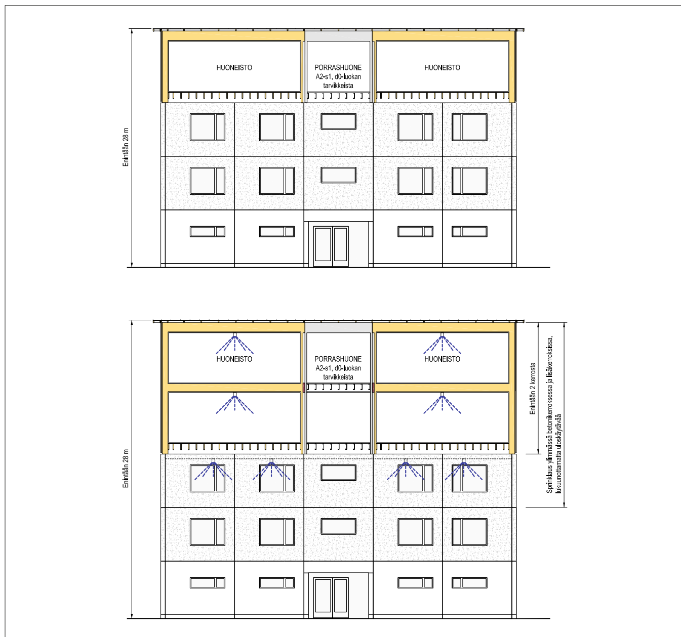
Kuva 13. Puurakenteisen lisäkerroksen sprinklauksen periaatteet P1-paloluokan asuinkerrostalossa.
