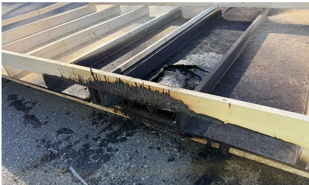
Kuva 3.16 – Koe 1 sivusauma koe-elementin alapuolelta kokeen jälkeen
