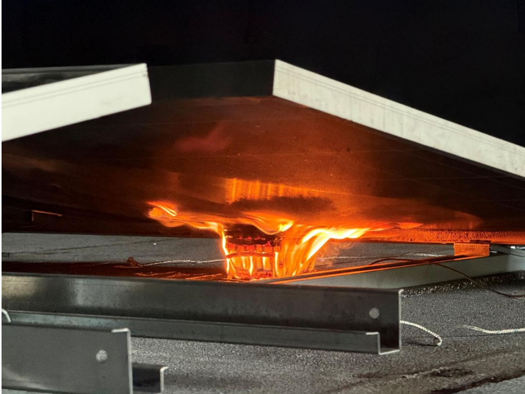
Kuva 2.1 – Aurinkopaneelin muodostamassa ontelossa sivulle taittuva liekki
