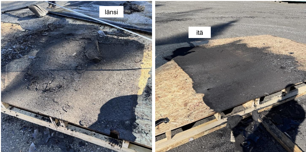
Kuva 3.27 – Koe 2 vaurioitunut OSB-levy
