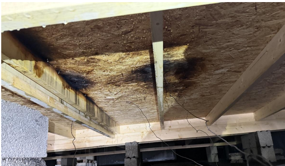
Kuva 3.54 – Koe 4 koe-elementin alapuoli kokeen jälkeen
