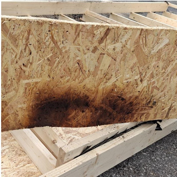
Kuva 3.57 – Koe 4 hiiltymisen sytytyslähteen alapuolella
