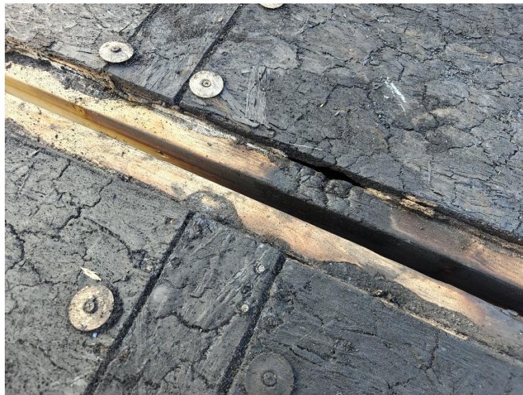
Kuva 3.42 – Koe 3 sivusauma-alue kokeen jälkeen
