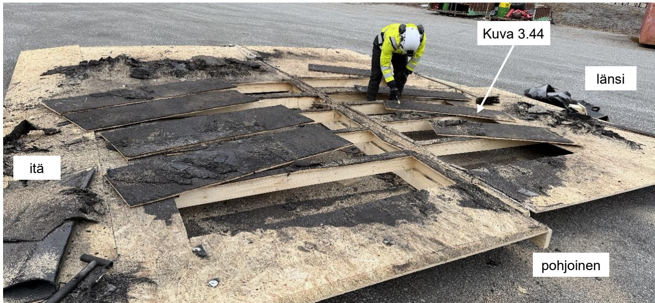
Kuva 3.43 – Koe 3 OSB-levyn sahaukset
