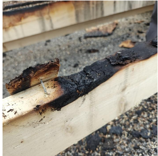
Kuva 3.57 – Koe 4 hiiltymisen sytytyslähteen alapuolella
