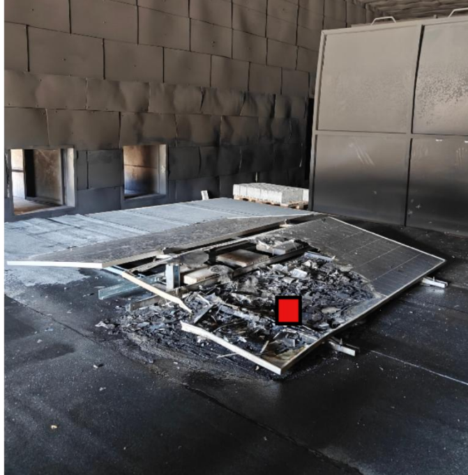
Kuva 3.10 – Koe 1 kokeen jälkeen (punainen neliö kuvaa sytytyslähteen sijaintia)
