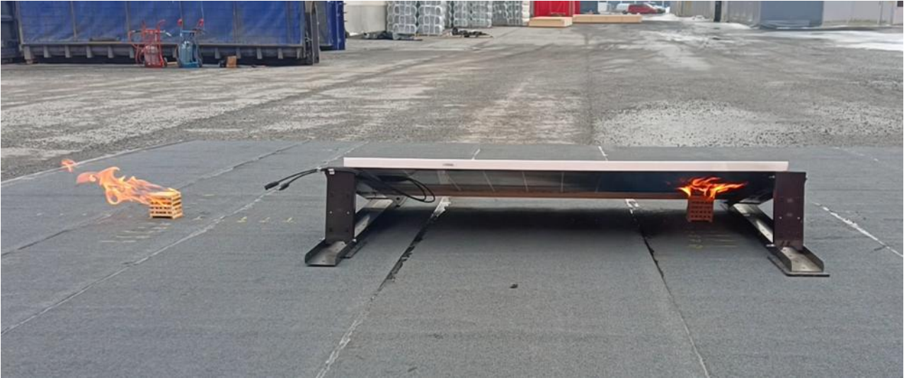
Kuva 7 – Testiasetus kaksinkertaisella sytytyslähteellä
