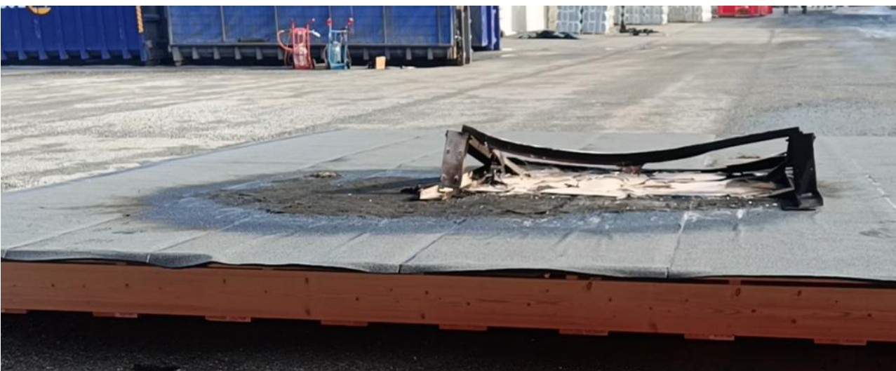
Kuva 8 – Testiasetus kaksinkertaisella sytytyslähteellä palon jälkeen
