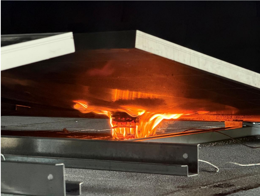
Kuva 2.1 – Aurinkopaneelin muodostamassa ontelossa sivulle taittuva liekki
