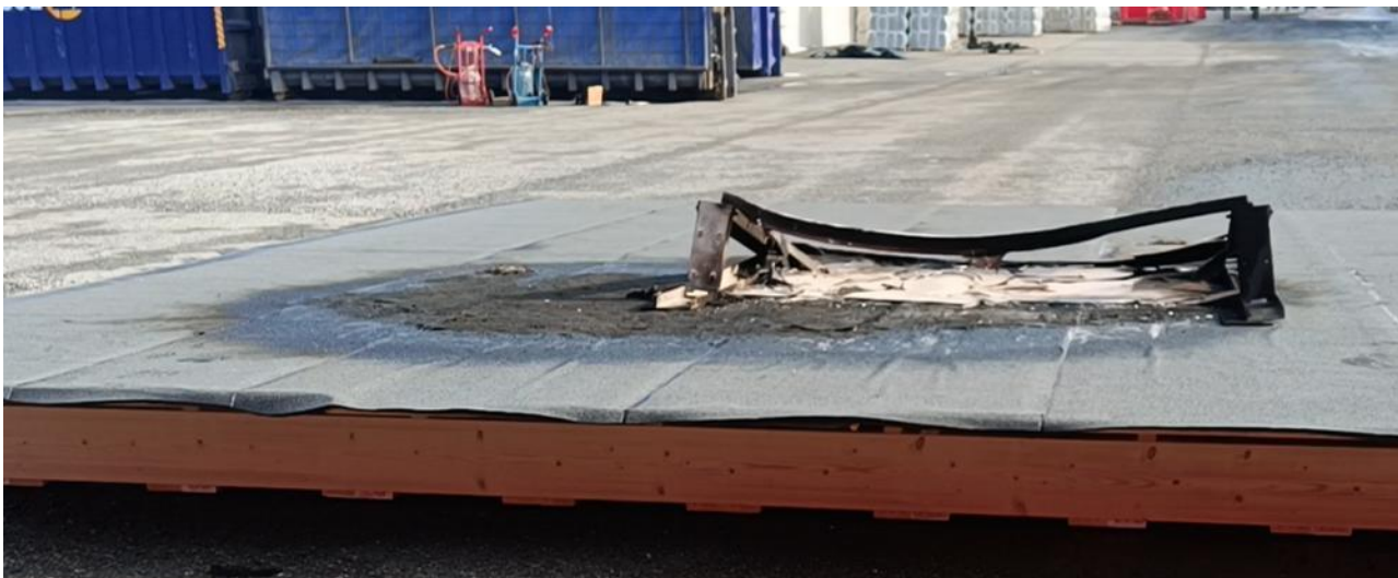
Kuva 8 – Testiasetus kaksinkertaisella sytytyslähteellä palon jälkeen
