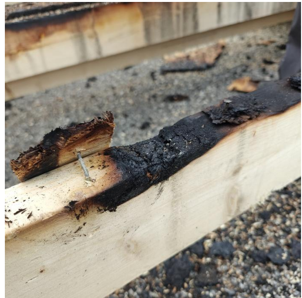
Kuva 3.57 – Koe 4 hiiltymisen sytytyslähteen alapuolella
