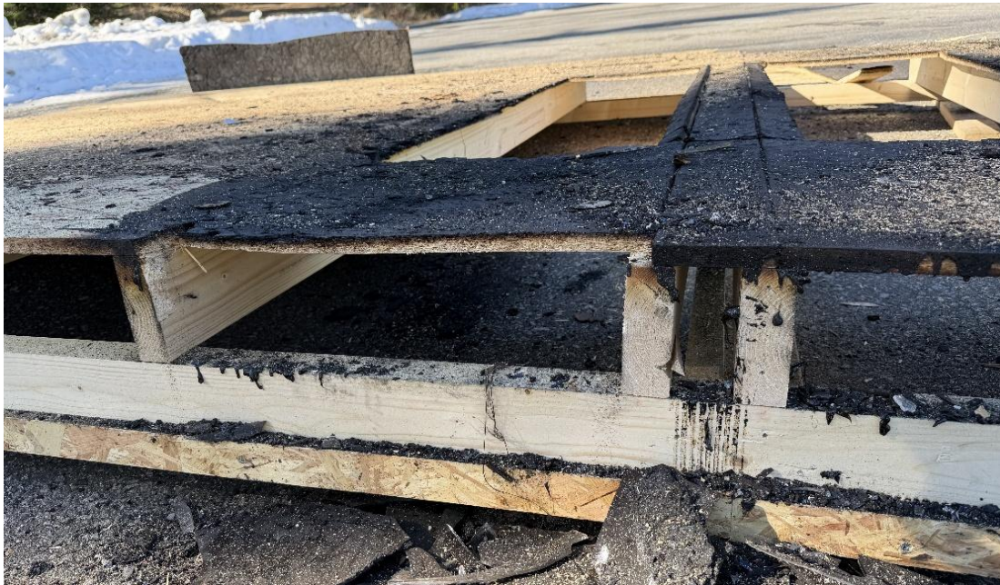
Kuva 3.29 – Koe 2 sivusauma-alue kokeen jälkeen
