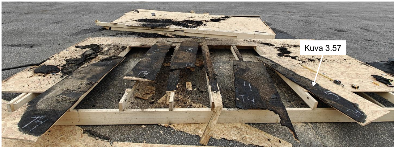
Kuva 3.56 – Koe 4 OSB-levyn sahaukset
