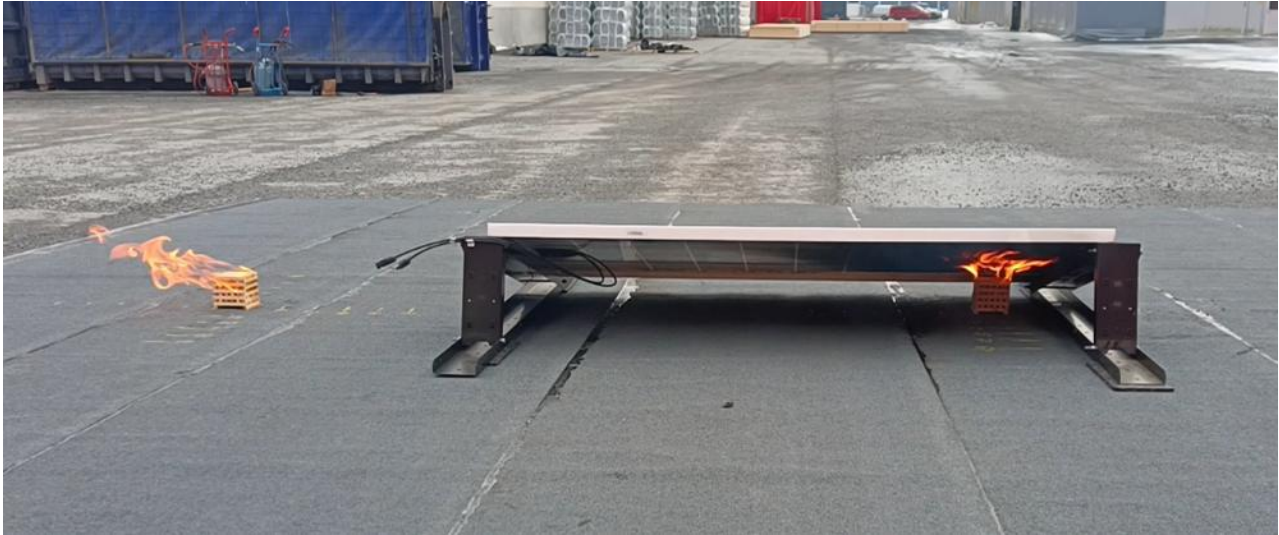
Kuva 7 – Testiasetus kaksinkertaisella sytytyslähteellä
