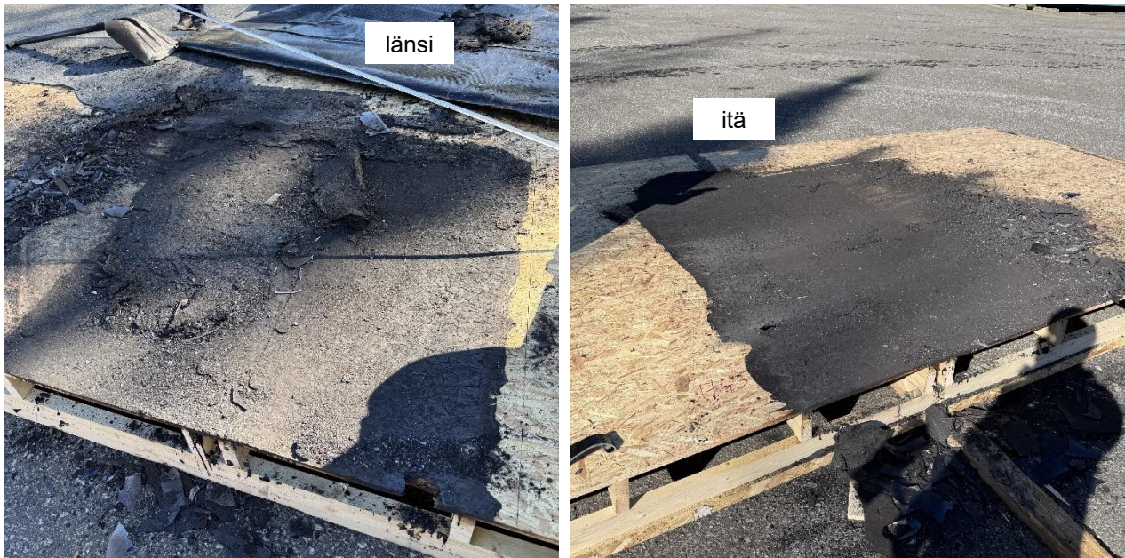
Kuva 3.27 – Koe 2 vaurioitunut OSB-levy
