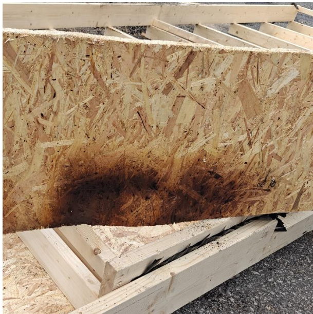
Kuva 3.57 – Koe 4 hiiltymisen sytytyslähteen alapuolella
